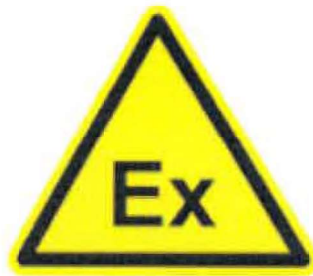
8 pav. Įspėjamasis ženklas apie potencialiai sprogia aplinką.
