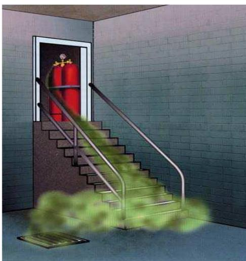
**Рис. 7.** Места скопления газа, являющегося тяжелее воздуха
