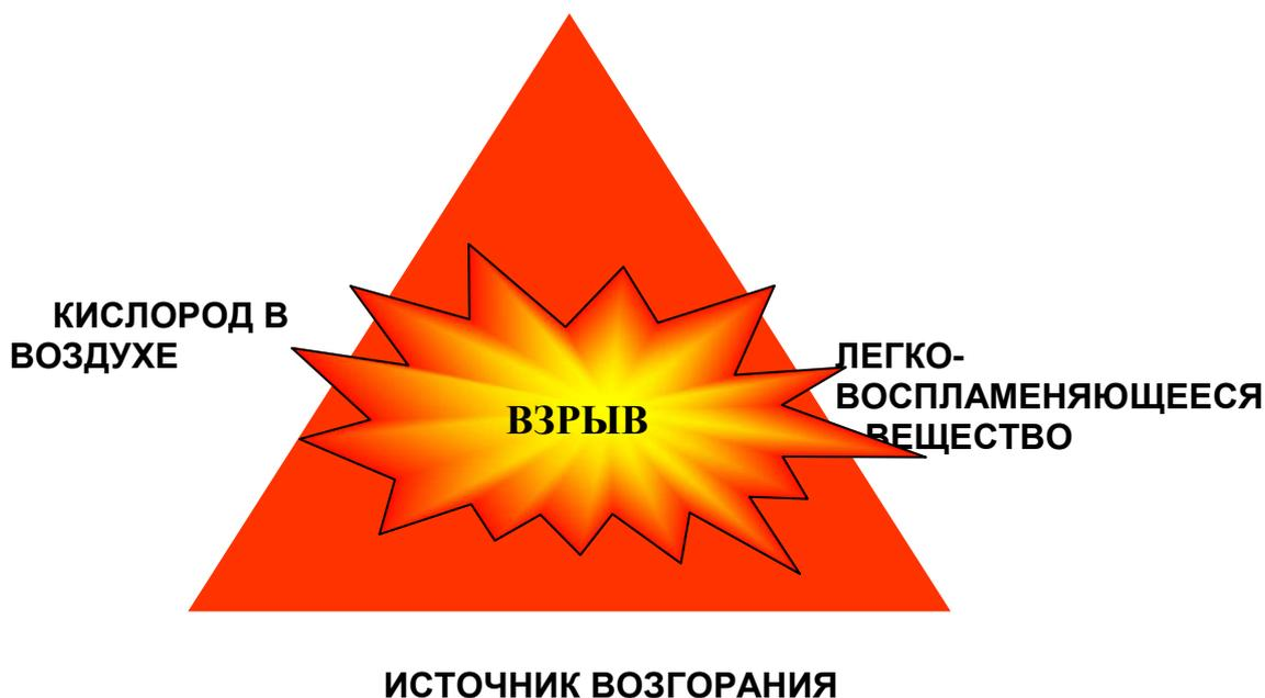
**Рис. 4.** Треугольник взрыва – необходимые условия для возникновения взрыва
