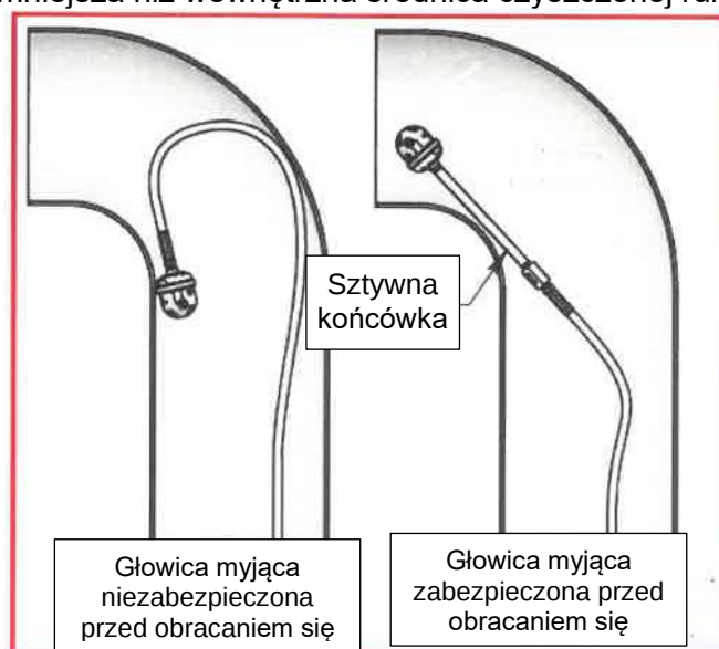
Rys. 2. Sztywna końcówka węża, chroniąca przed obrotem głowicy myjącej w rurze
