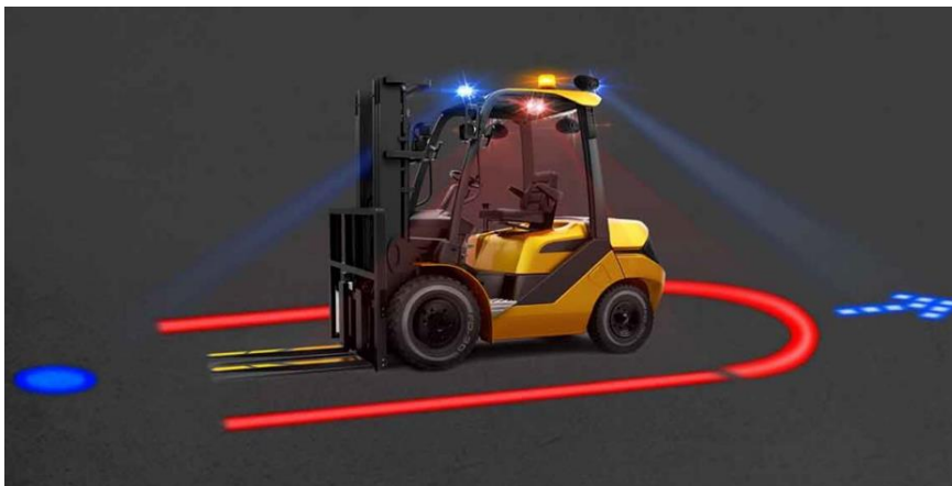
Rys. 4. Przykład sygnalizacji świetlnej ostrzegawczej i oświetlenia strefy bezpieczeństwa
