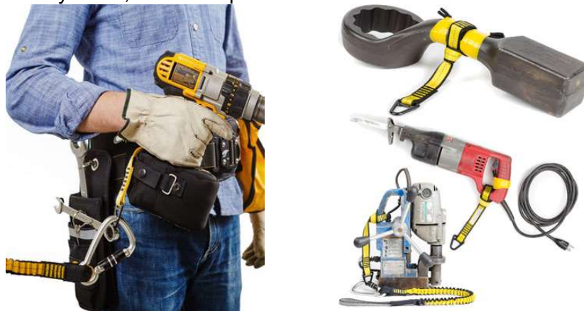
6 rys. Przykłady mocowania narzędzi
