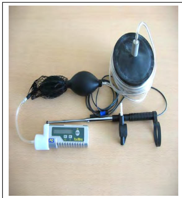
11 pav. Dujų analizatorius ToxiRAE
